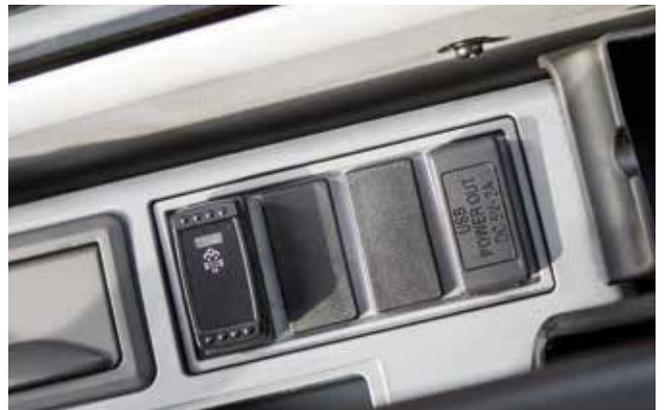
La source d'alimentation USB est utile pour le chargement d'appareils portables, tels que des téléphones mobiles.
