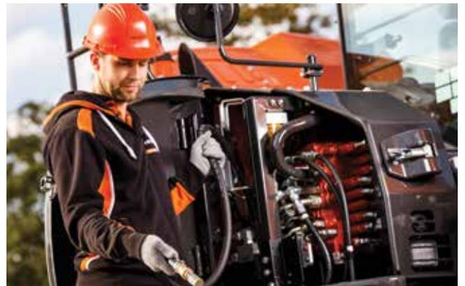
Le plein de l'excavatrice peut être effectué à l'aide d'une pompe électrique.
