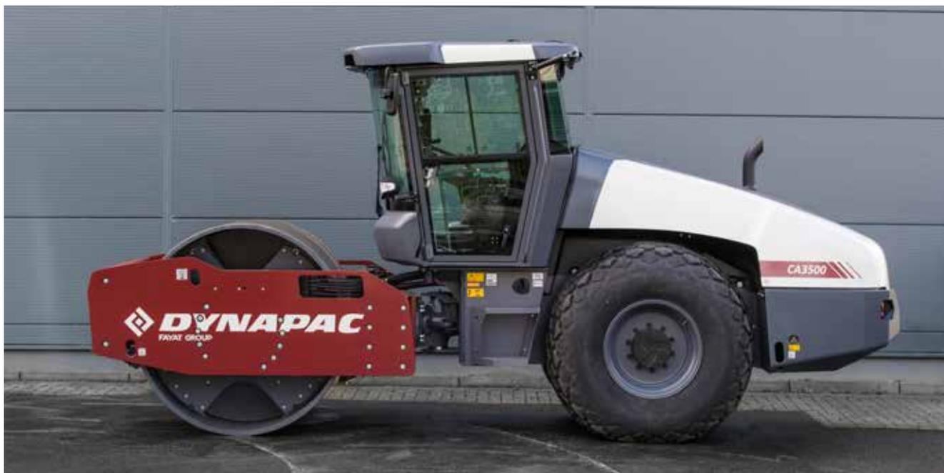
**Outils : Une cinquième génération de compacteurs Dynapac CA équipés d'un optimiseur de compactage qui intègre un compacimètre et un analyseur de compactage avec GPS (en option).**
